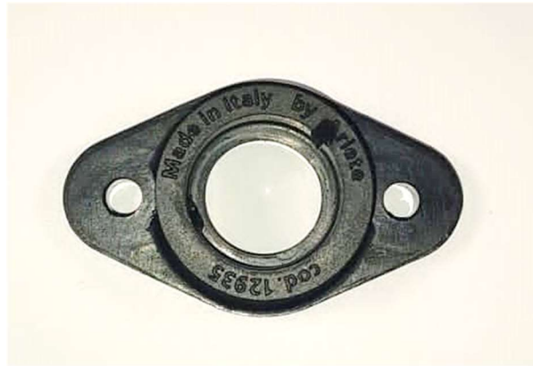
FOTO DEL SUPPORTO IN GOMMA DEL COLLETTORE DI ASPIRAZIONE PHOTO OF INTAKE MANIFOLD RUBBER MOUNT PHOTO DU SUPPORT EN CAOUTCHOUC DU COLLECTEUR D'ADMISSION
